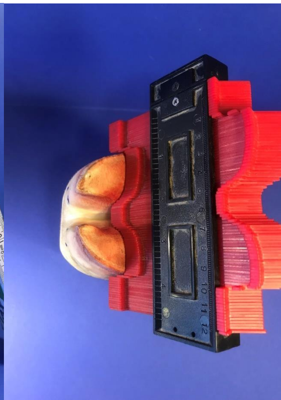
Abbildung 15: Abdruck Hohlkehlung von oben (Eigenfoto)
