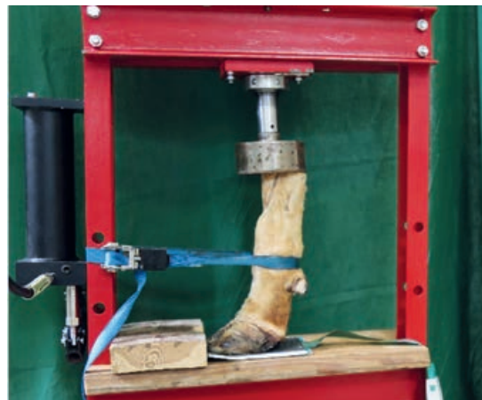
Abb. 2: Versuchsaufbau zur Druckmessung unter der Klaue. Auf dem Laptopmonitor ist die Druckbelastung und -verteilung während der Messung in Echtzeit zu sehen.
